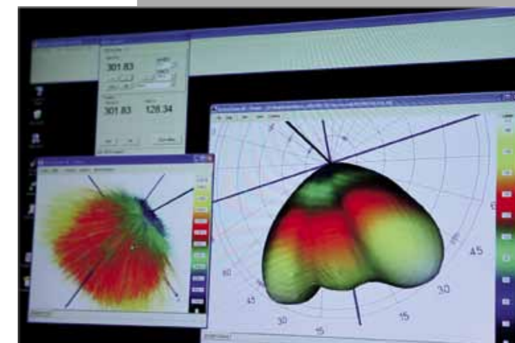
Acima, equipamento em funcionamento. Abaixo, gráficos em três dimensões das curvas fotométricas.
