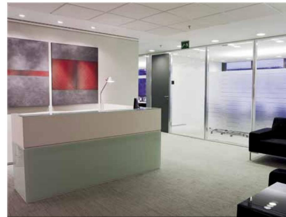
A sala de espera e circulação principal foram iluminadas por lâmpadas halógenas PAR 20 de 50W e ângulo de abertura de 30° em luminárias com fecho de luz direcionado para as alvenarias.
