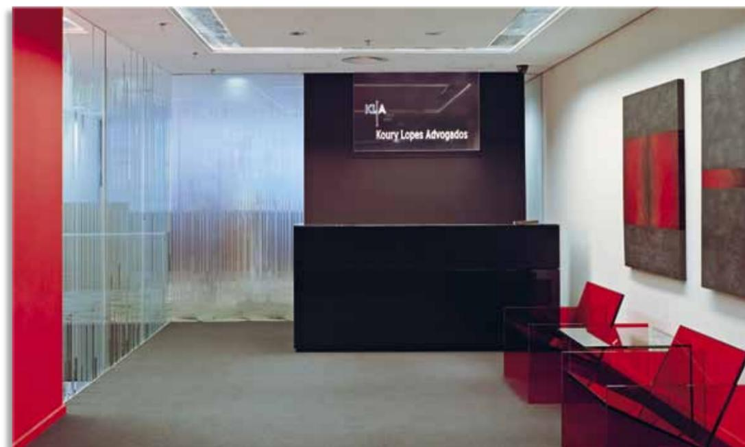
A recepção recebeu fluorescentes tubulares T5 de 28W e 4000K com fechamento em acrílico translúcido e difusor em grelha plástica duplo parabólica com filme prata especular.
