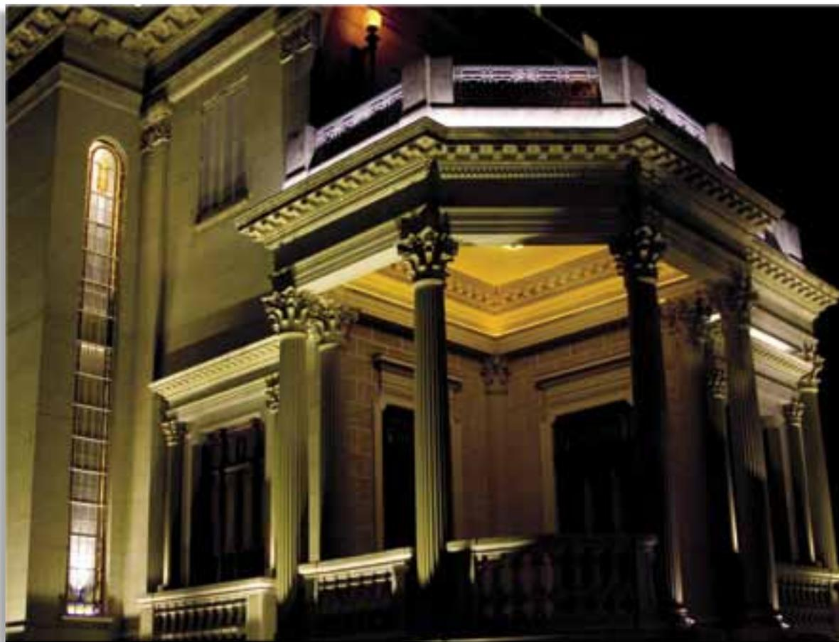
Varanda com fitas flexíveis de LED a 3200K na cimalha e na cor âmbar na parte interna.
