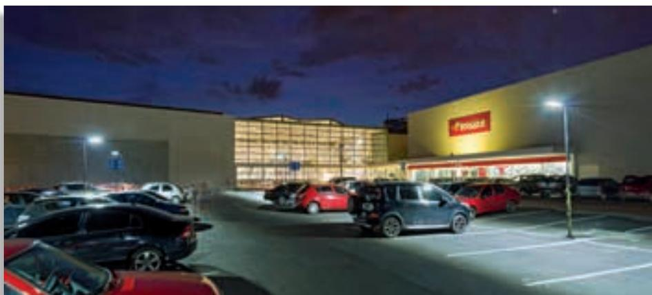
Acima, fitas de LED RGB de 8W/m destacam as sancas dos corredores externos. Ao lado, estacionamento com 143 pétalas de LED de 60W a 4000K, instaladas a quatro metros de altura.
