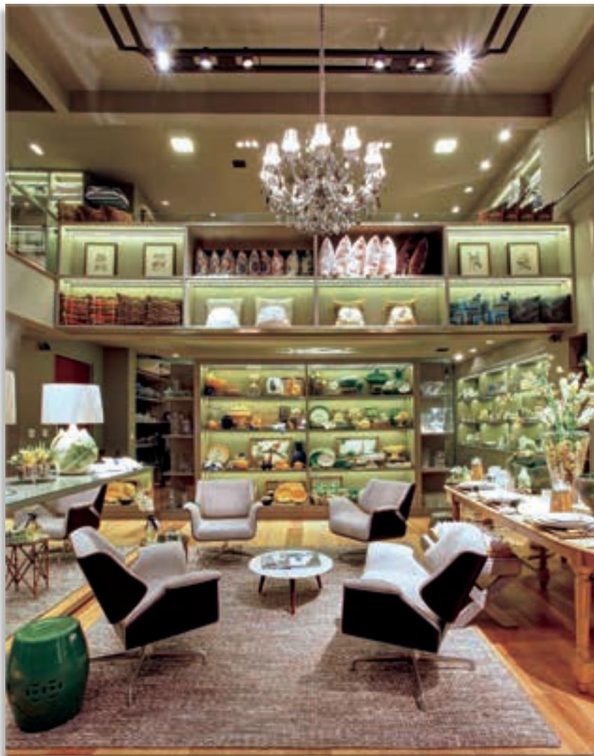
Prateleiras receberam dois rasgos na parte superior de cada um dos nichos, sendo um na frente e outro no fundo, com fitas de LED de 0,8W/m. Lâmpadas de vapor metálico de 35W/24° em trilho eletrificado completam a iluminação dos produtos expostos.
