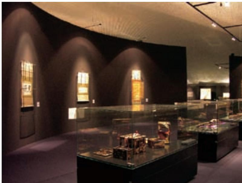
Para as obras expostas em móveis fechados, próximos a paredes do museu e paredes expositivas, Guinter optou por uma iluminação downlight, usando spots de sobrepôr, com lâmpadas halógenas dicróicas 50W de fachos variados, instalados nas extremidades de hastes em tubo de aço carbono. “Nesse caso, a potência da lâmpada foi maior em função da distância, também maior, entre a lâmpada e a peça a ser focalizada”, diz Guinter.
