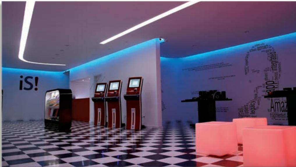
No salão principal, fitas de LED RGB de 72W/m instaladas em sanca contornam o ambiente, enquanto rasgos no forro, equipados com fitas de LED de 72W/m a 4500K, auxiliam a iluminação.
