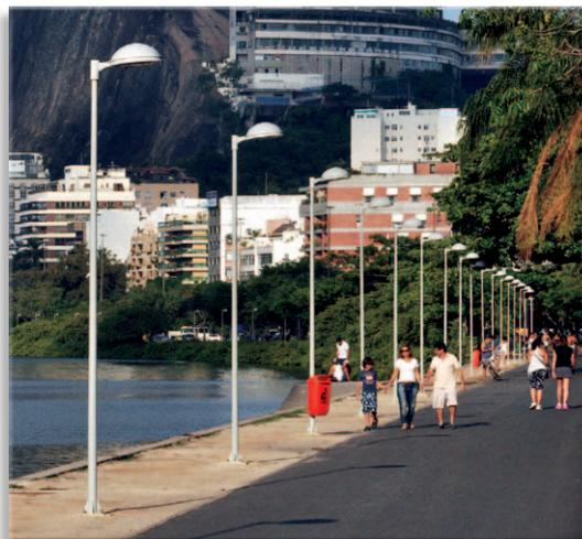
Acima, detalhes das novas luminárias Evolve™ Iberia LED de 90W a 4300K em postes de 4,5 metros de altura instaladas na ciclovia da Lagoa.
