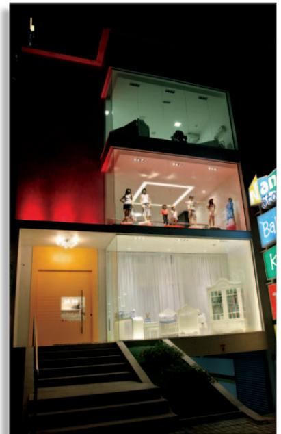
Projetores de LED RGB de 36W instalados sobre a marquise cria efeitos de luz na parede da fachada.
