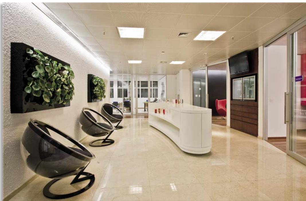
As áreas de circulação receberam sistema de calhas especiais com refletores internos de alto brilho e grelhas antiofuscantes equipadas com fluorescentes T5 de 28W a 4000K.
