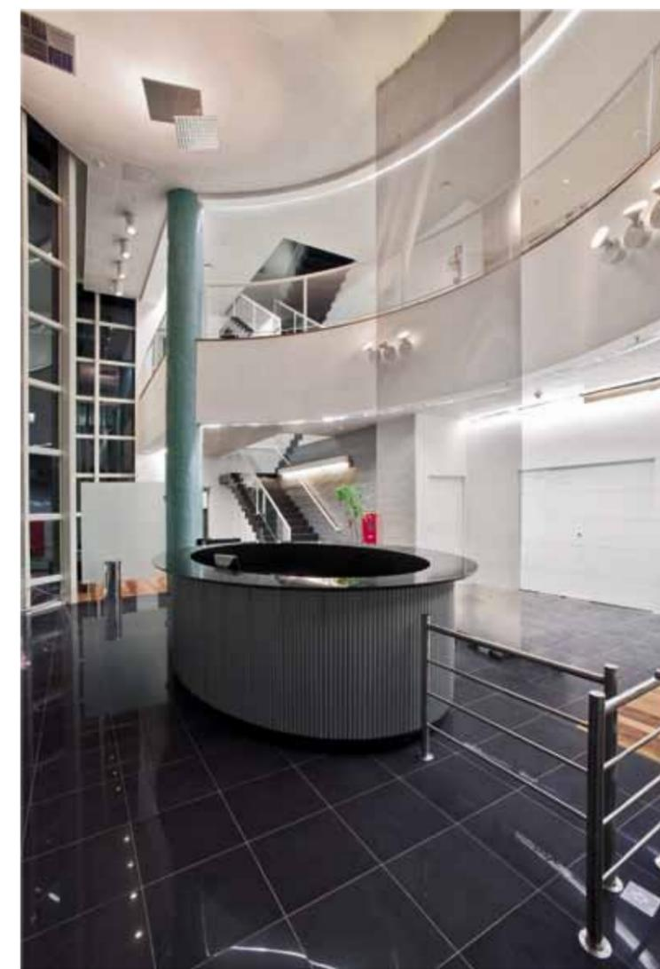
Malha de inox, posicionada atrás do balcão da recepção, recebeu luz por réguas de LED de 30W instaladas no piso.
