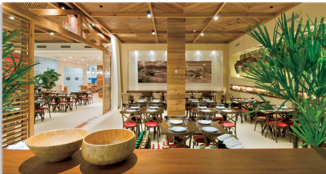
À esquerda, forro de madeira recebeu luminárias de sobrepor com lâmpada refletora CDMR PAR 30 de 35W/30° a 3000K.
