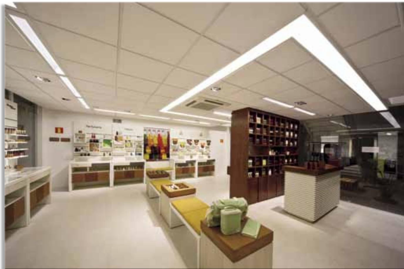
equipamentos para reposição e manutenção em diferentes cidades brasileiras. As luminárias especificadas, inclusive as LEDs, são de fabricantes brasileiros. As fontes luminosas adotadas apresentam eficácia mínima de 70 lúmens por watt, sendo que boa parte chega a 100 lúmens por watt.
