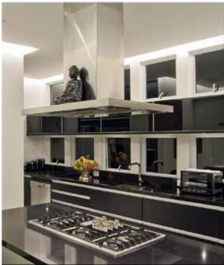
Acima, fluorescentes T5 com temperatura de 3000K instaladas em sancas no teto iluminam a cozinha.
