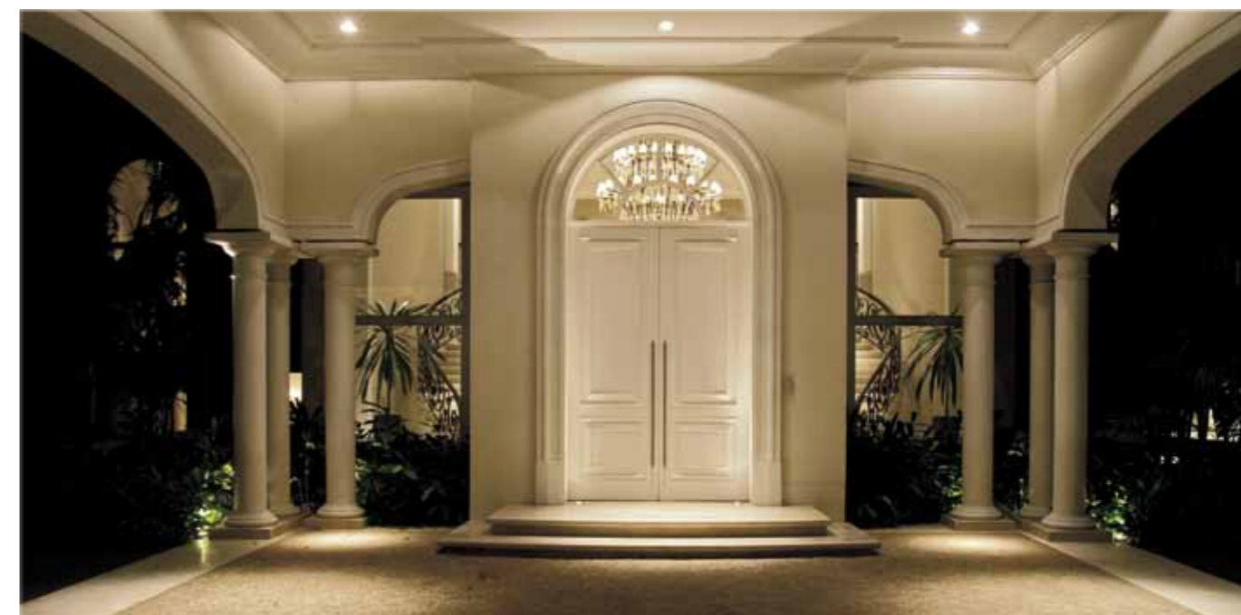
Halógenas AR70, de 50W e 8° de abertura foram embutidas no solo da porta de entrada da casa.
