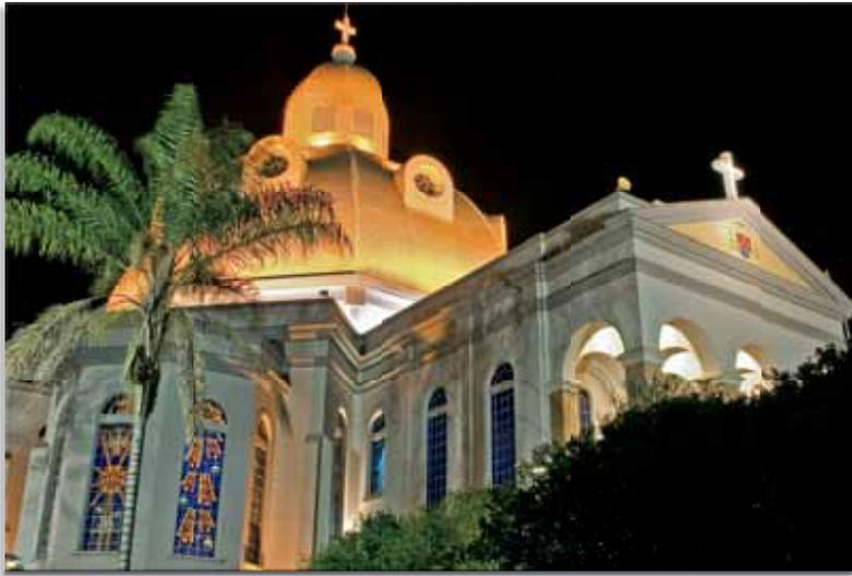
de 250W e temperatura cor a 4200K, instalados em postes no jardim com 9 metros de altura. Este posicionamento das fontes de luz resultou na projeção de sombras dos galhos de árvores em toda fachada da edificação.
