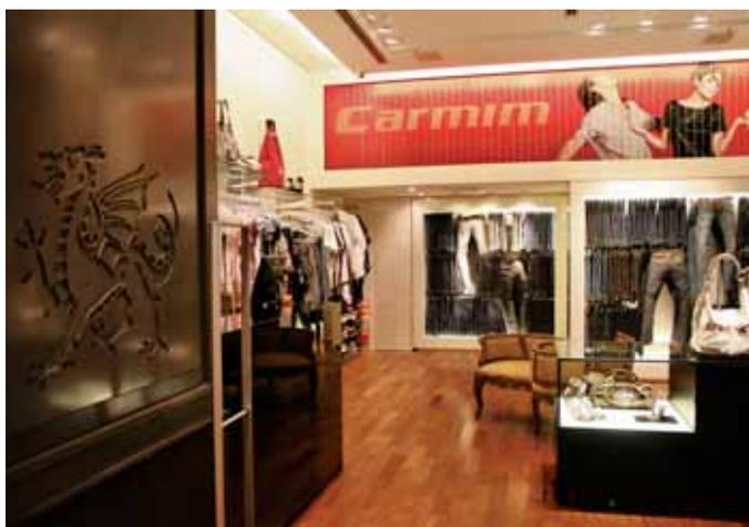
instalados sete embutidos com lâmpadas de vapor metálico CDMR AR 111, de 24° de abertura, 35W e 3000K, que iluminam as calças jeans. Esta diferença, segundo Junia, foi para dar mais intensidade para o tecido iluminado.
