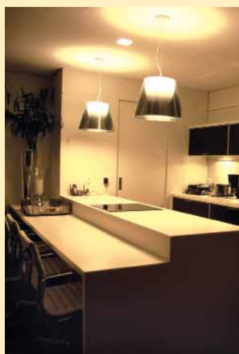
Dois pendentes são destaques da iluminação decorativa e funcional da cozinha. Entre eles, um embutido no teto reforça a iluminância neste plano, resultando numa luz difusa e suave.
