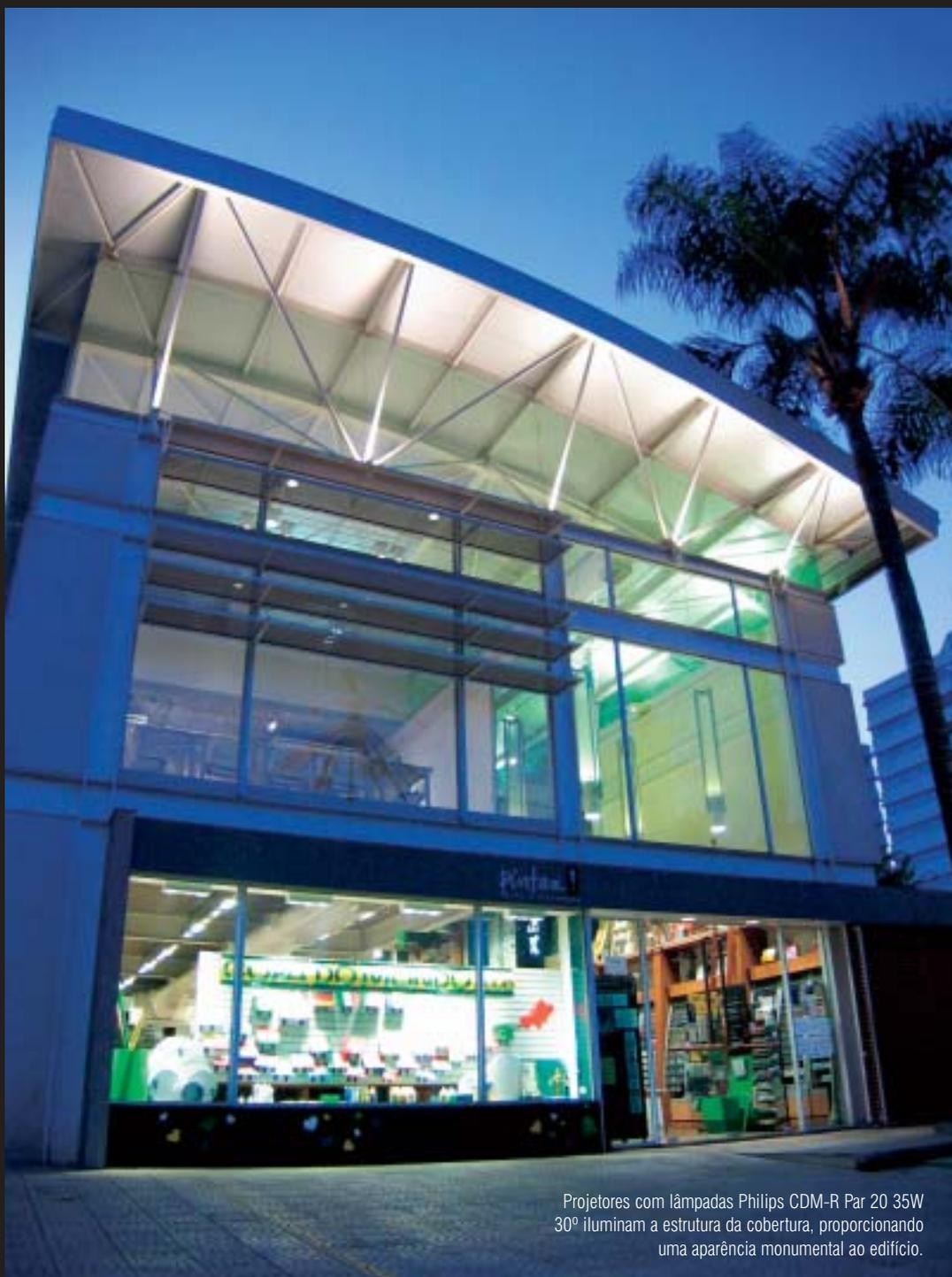
Projetores com lâmpadas Philips CDM-R Par 20 35W 30° iluminam a estrutura da cobertura, proporcionando uma aparência monumental ao edifício.
