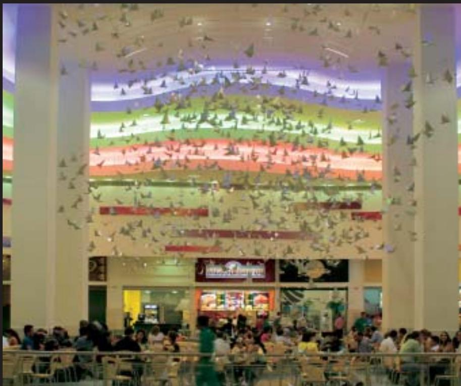
A iluminação com *changing color* em fluorescente RGB destacou uma sucessão de curvas no teto da praça de alimentação. O controle permite fixação numa cor e efeito arco-íris.
