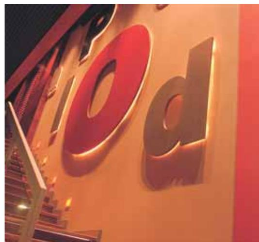
Na escada, LEDs de 1W são intercalados nas cores âmbar e vermelho, dando bom resultado decorativo. Funcionam como balizadores e destacam os degraus da escada.
