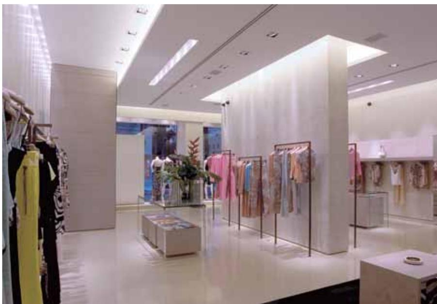
para o embutimento de luminárias do tipo *down light* para lâmpadas PAR 20, de 50W / 30°, proporcionando, assim, um desejável clareamento nas superfícies verticais da loja.
