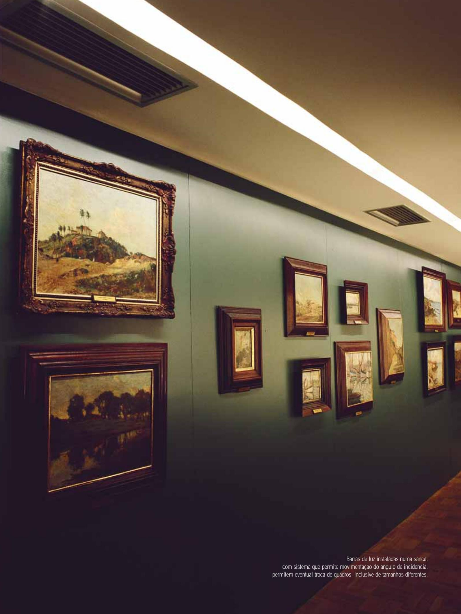
Barras de luz instaladas numa sanca, com sistema que permite movimentação do ângulo de incidência, permitem eventual troca de quadros, inclusive de tamanhos diferentes.
