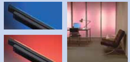
Pioneira no desenvolvimento de sistemas color changing, a Martin Architectural destacou o **Cyclo 03 DMX HO**, uma luminária com lâmpadas fluorescentes T5 de 54w, desenhada para iluminação de fundo e efeitos decorativos para interiores. Utilizando lâmpadas standard T5 e um controlador DMX, a luz branca e a colorida é obtida pela combinação e dimerização de três lâmpadas com as cores vermelha, verde e azul (RGB).
