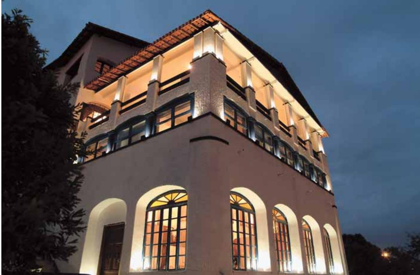
Foram usadas fluorescentes eletrônicas de 9W / 4000K, nas áreas onde a altura a ser iluminada era menor, e de 26W para as partes mais altas.
